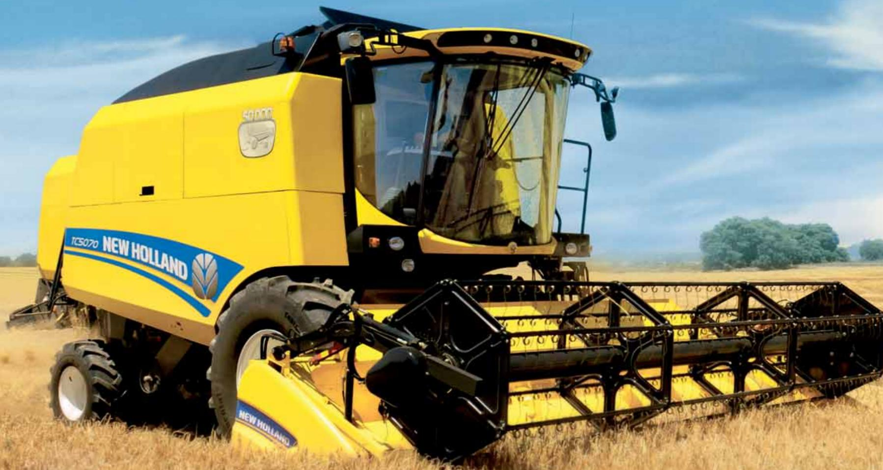
permettent d'accroître vos rendements. En effet, elles peuvent travailler plus longtemps sans faire de vidange. Ensuite, avec un débit de vidange de 72 litres/seconde, même la plus grande trémie peut être vidée en un temps record de 90 secondes.
