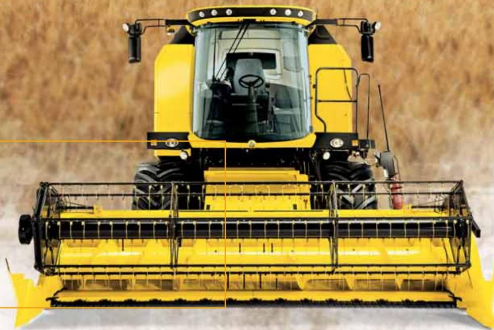
empêche l'accumulation de grain et menues pailles et peut compenser les pentes latérales jusqu'à 25 %. Le caisson de nettoyage en double cascade permet d'obtenir une surface de nettoyage exceptionnelle atteignant 4,23 m<sup>2</sup>. Résultat : la capacité de nettoyage est augmentée de 30 % dans les conditions de charge les plus sévères. En outre, le système Opti-Fan™, déjà utilisé
